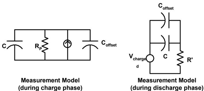
电容是通过测量“极短”时间内 ( $\Delta t$ ) 发生的电压变化 ( $\Delta V$ ) 计算出来的。测量周期包括两个部分：充电阶段和放电阶段。
