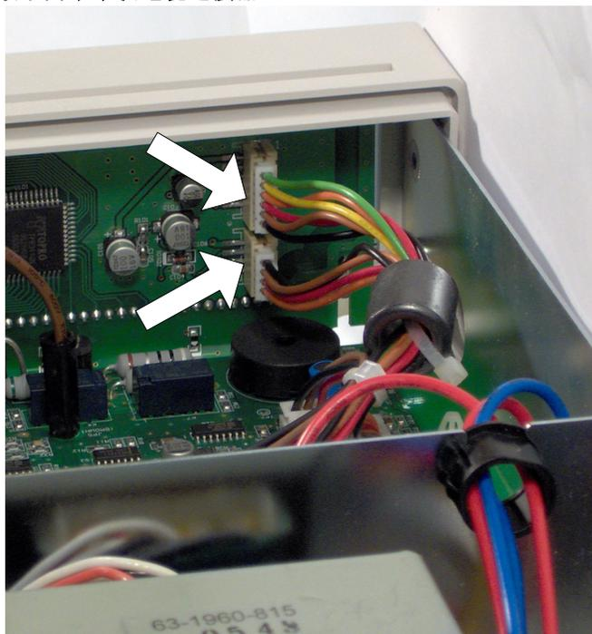
9 断开下图所示的各个面板线。
