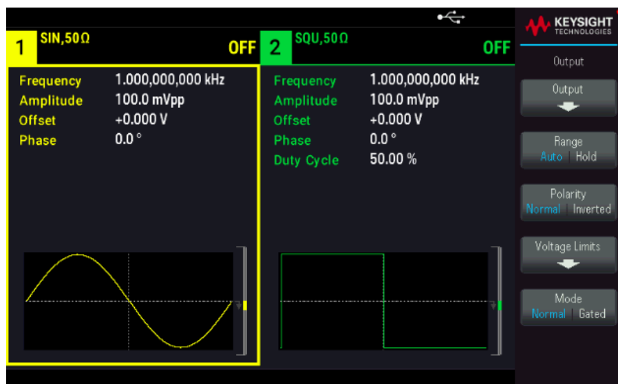
図2. 標準の正弦波および方形波のデュアル画面表示
