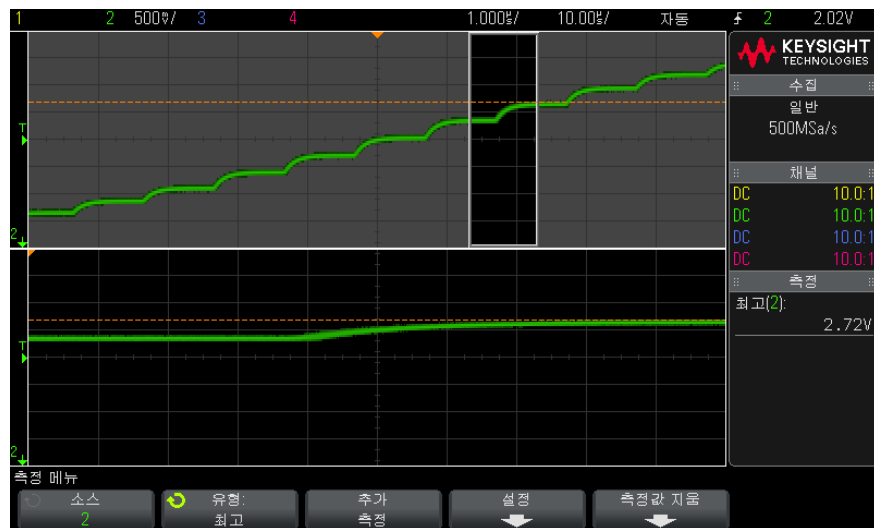
그림 46 최고값 측정을 위한 영역 격리
