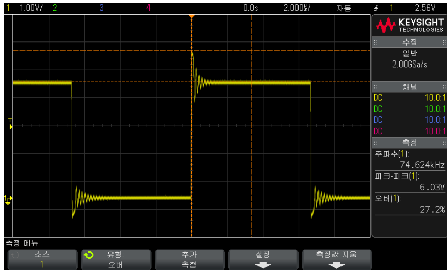
그림 47 자동 오버슈트 측정
