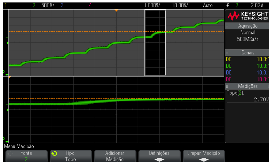
Figura 46 Isolar área para medição de topo
