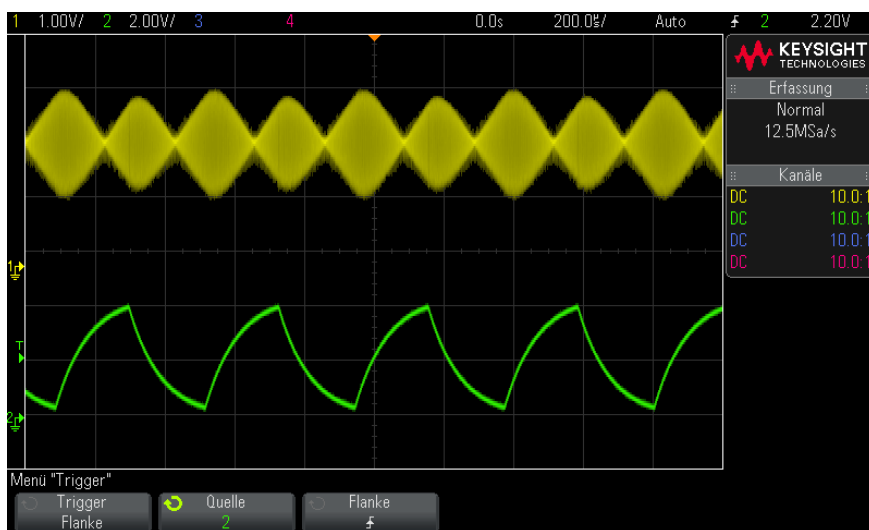
Abbildung 26 Amplitudenmodulation bei 40% Intensität
