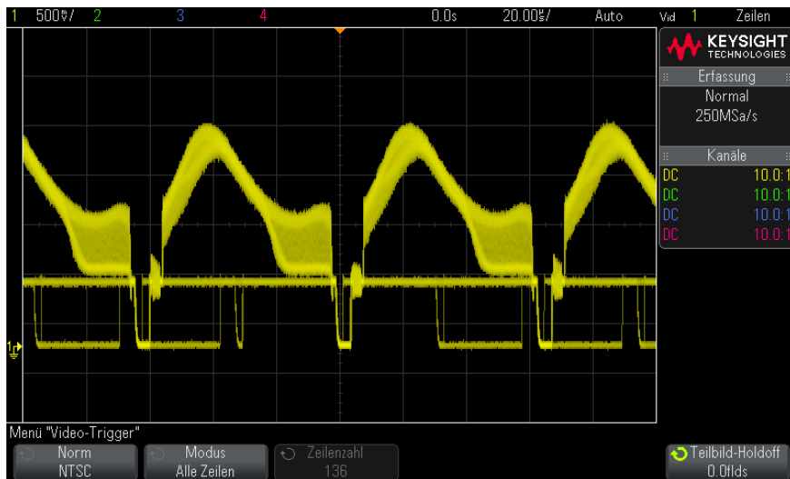
Abbildung 28 Triggerung auf alle Zeilen
