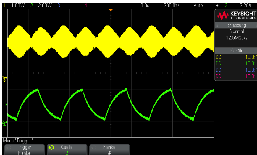
Abbildung 25 Amplitudenmodulation bei 100% Intensität
