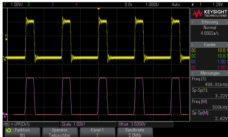
Abbildung 15 Beispiel für Tiefpassfilter
