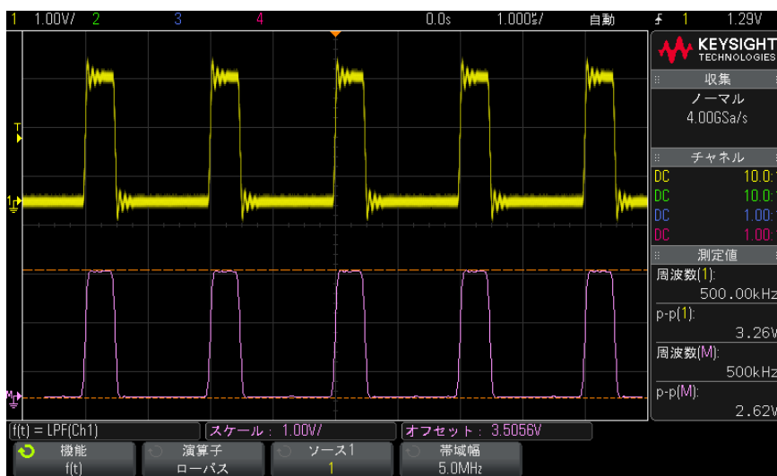
図 15 ローパス・フィルタの例
