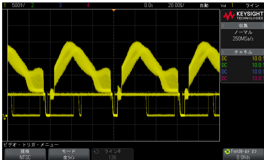
図 28 すべての走査線でのトリガ
