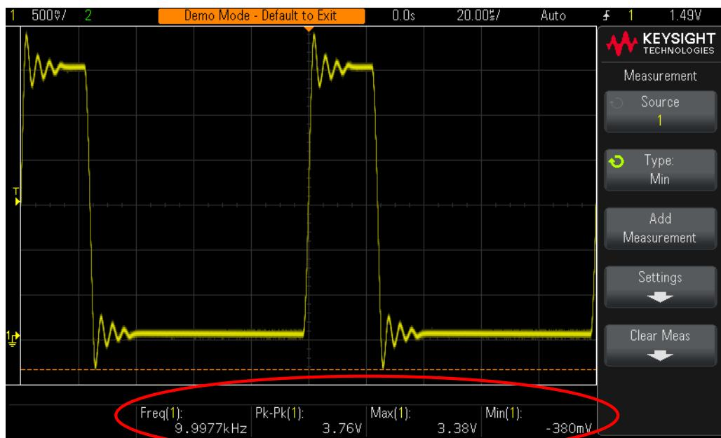
그림 32 스코프가 자동으로 최대 4개의 파라미터를 측정합니다.
