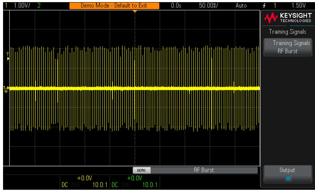
그림 43 더 느린 타임베이스 설정을 사용하여 여러 RF 버스트 파형 캡처
