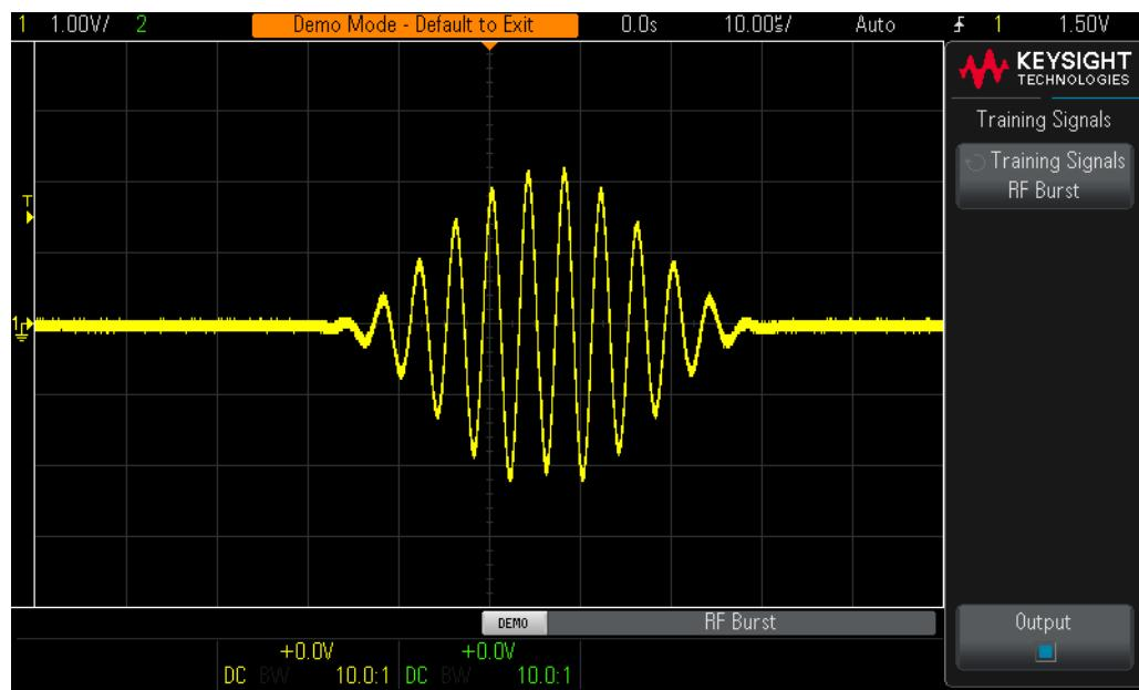
그림 42 200.0ns/div에서 RF 버스트 캡처 및 표시
