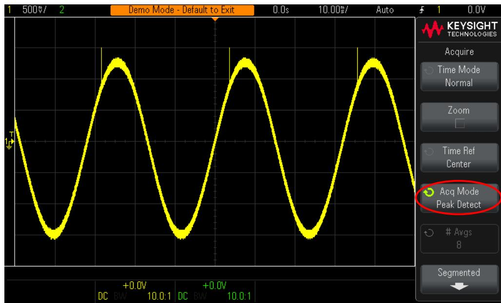
**그림 41** 피크 검출 수집 모드는 느린 사인파 위에 있는 좁은 글리치를 안정적으로 캡처합니다.
