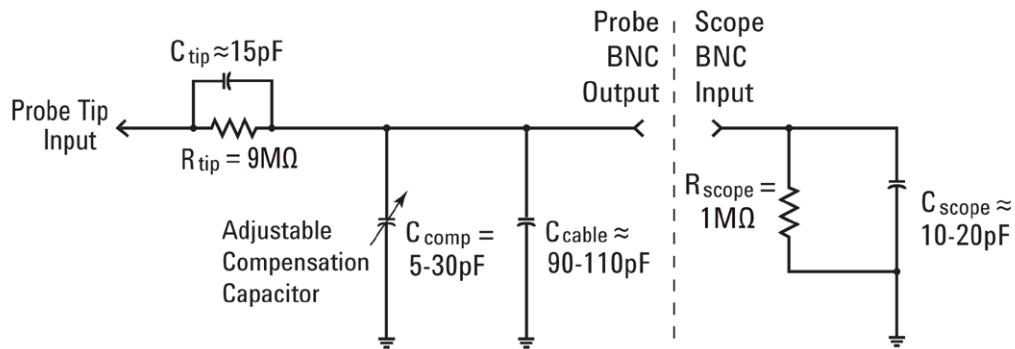
**그림 20** 스코프의  $1\text{M}\Omega$  입력 임피던스에 연결된 패시브 10:1 프로브의 간단한 도식
