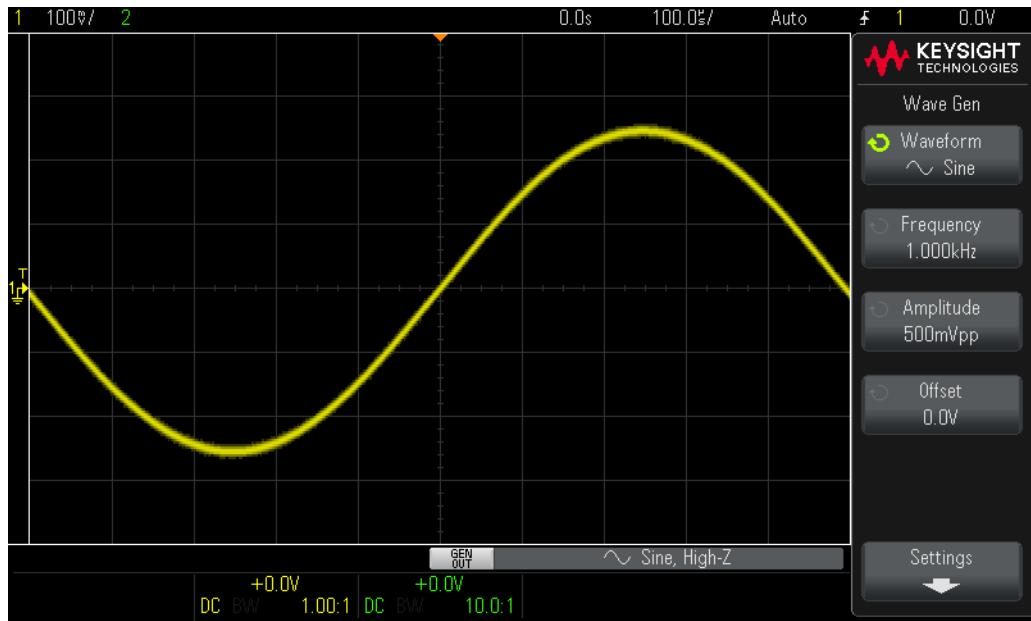
그림 24 스코프의 내장 파형 발생 함수 발생기 사용
