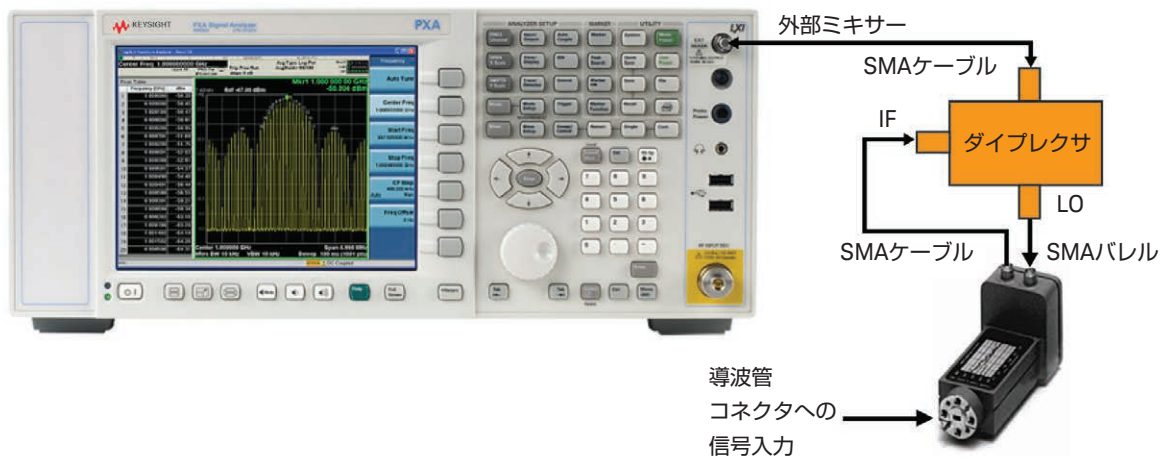
図1. 従来の11970ミキサーの接続にはダイプレクサの他に、PXAシグナル・アナライザを接続するために追加のケーブルが必要でした。
