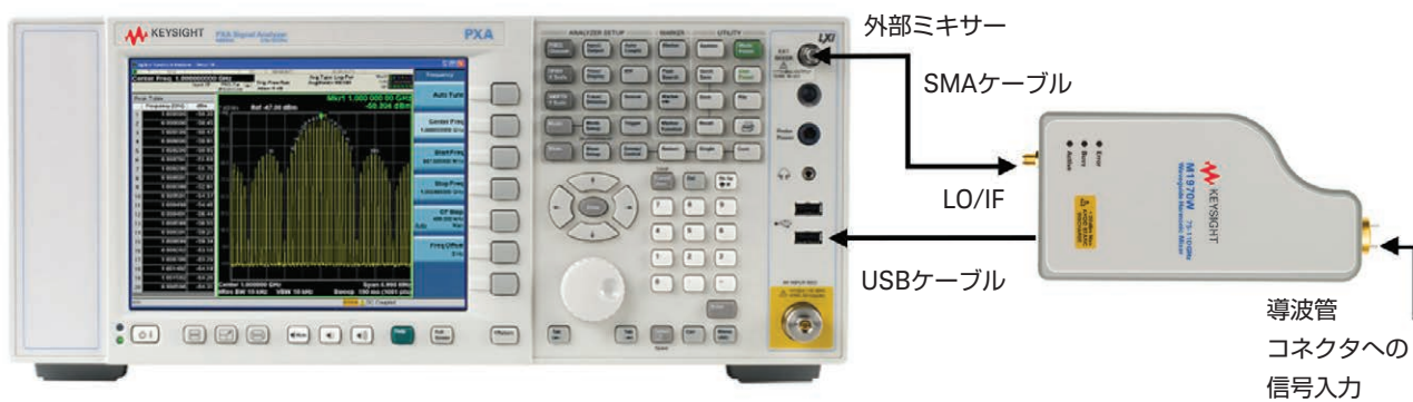
図2. スマートミキサーの接続は低コストで、SMA同軸ケーブル1本とUSBケーブル1本による最小限の接続で行えます。
