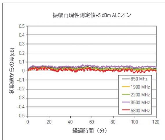
再現性は、任意の他の周波数/パワー設定値にランダムに変化させた後、与えられたパワー設定値に戻したときの測定器の性能を測定したものです。絶対レベル精度とは異なります。
