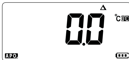
Figura 2-21 Misurazione della temperatura senza compensazione ambiente
