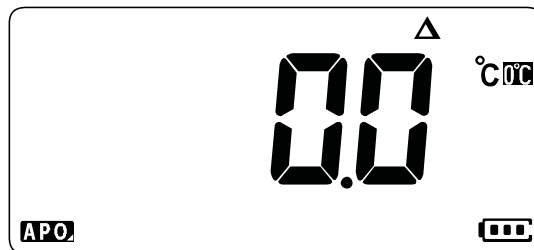
Figure 2-21 Mesure de température sans compensation ambiante
