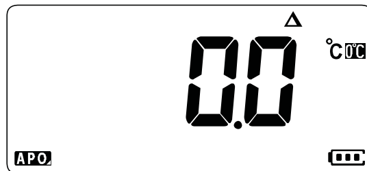
Figura 2-21 Medición de temperatura sin compensación ambiental
