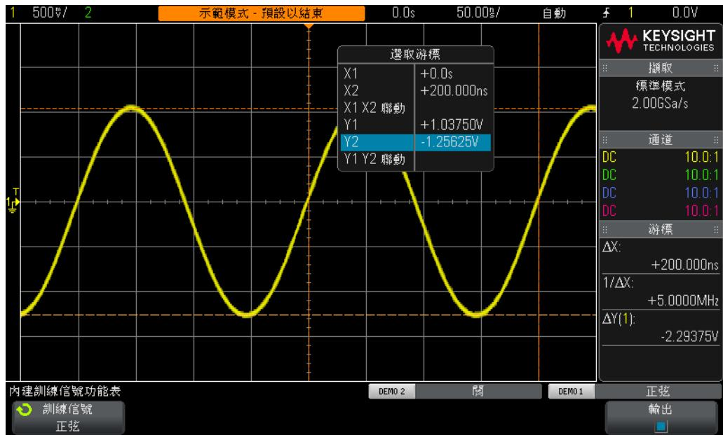
圖 11 使用示波器的游標量測
