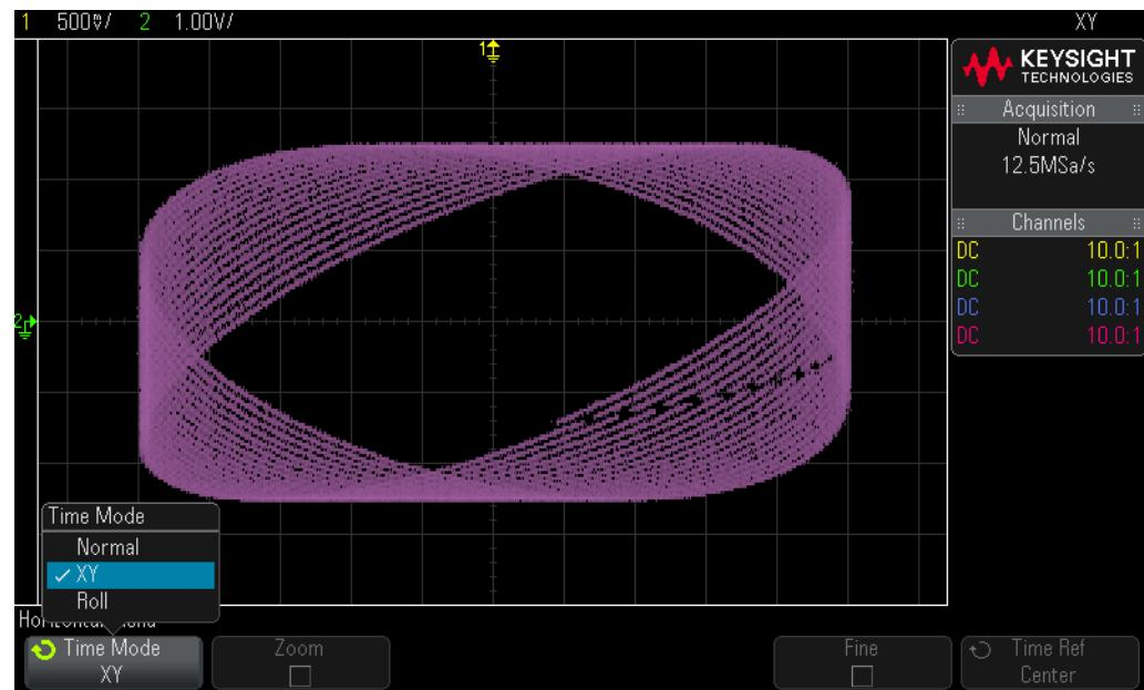
**圖 41** 頻率不同的兩個信號所產生的更複雜的 Lissajous 圖案
