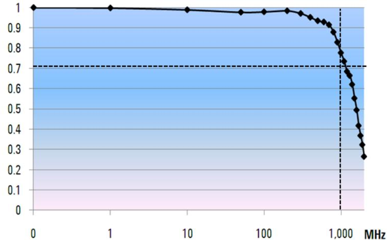
**圖 52** Keysight 1 GHz 頻寬示波器的實際頻率回應
