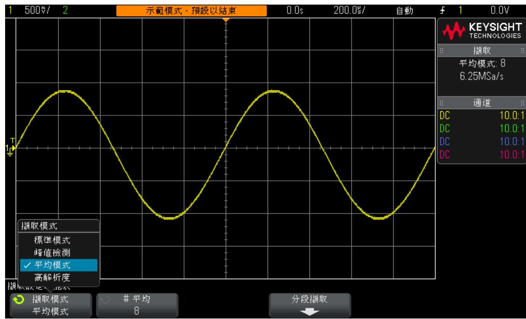
圖 17 使用示波器的平均擷取模式消除雜訊
