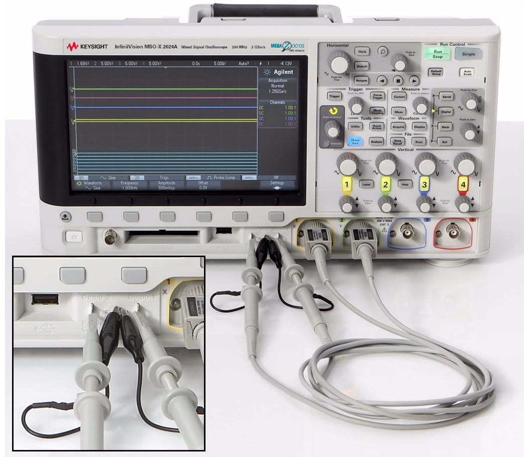
圖 8 將測試棒連接至通道 1／通道 2 輸入與訓練信號輸出端子之間
