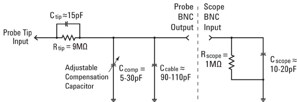
圖 20 連接至示波器  $1\text{ M}\Omega$  輸入阻抗之被動 10:1 測試棒的簡化電路圖
