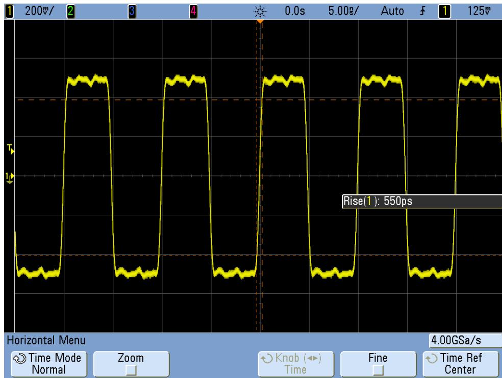
圖 55 在 1 GHz 頻寬示波器上擷取的 100 MHz 數位時鐘信號
