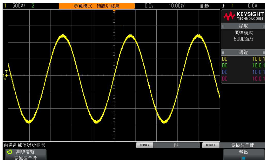
圖 44 示波器自動降低取樣率導致對重複的電磁波干擾取樣過疏
