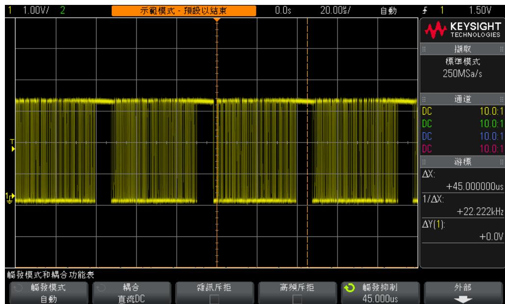
圖 27 使用示波器的觸發遲滯功能針對一組脈波執行同步
