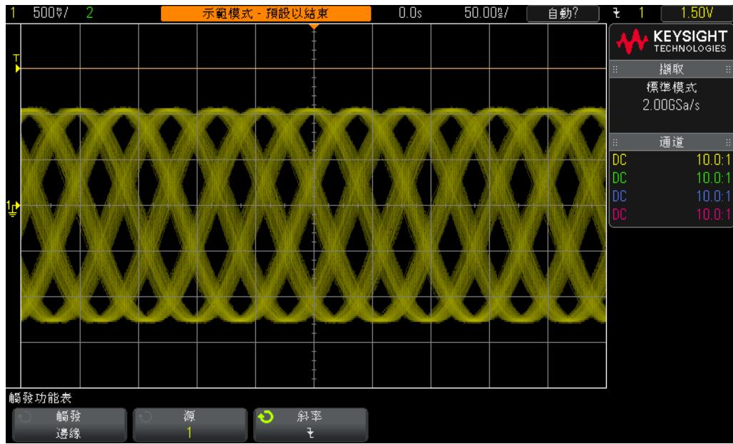
圖 14 觸發位準的設定高於輸入信號時的自動觸發
