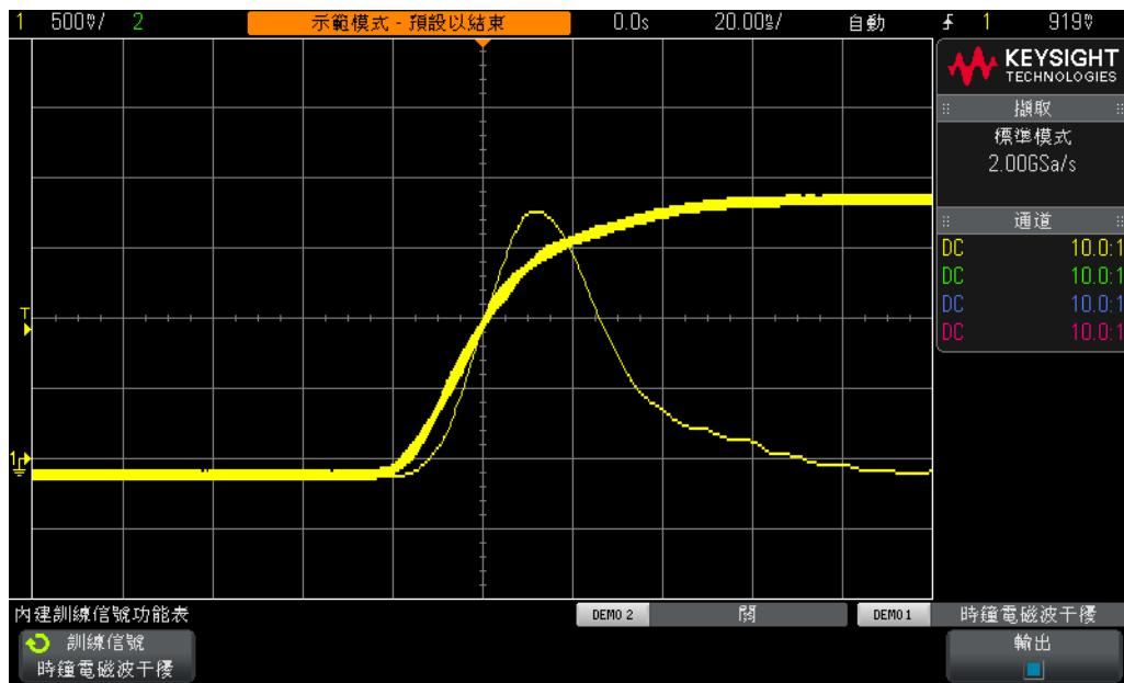
圖 28 示波器的快速波形更新率擷取不常出現的電磁波干擾
