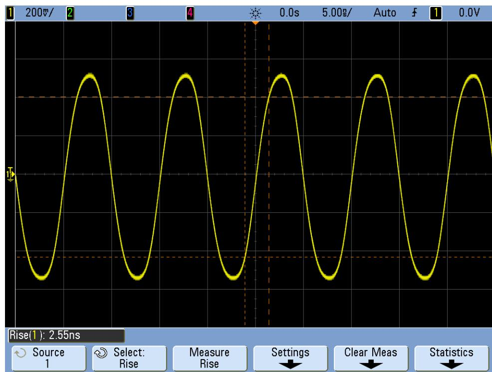
圖 53 在 100 MHz 頻寬示波器上擷取的 100 MHz 數位時鐘信號
