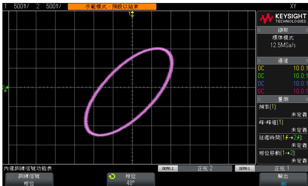
圖 40 對頻率相同，但相位相差 48 度的兩個正弦波使用示波器的 XY 模式產生的 Lissajous 圖案
