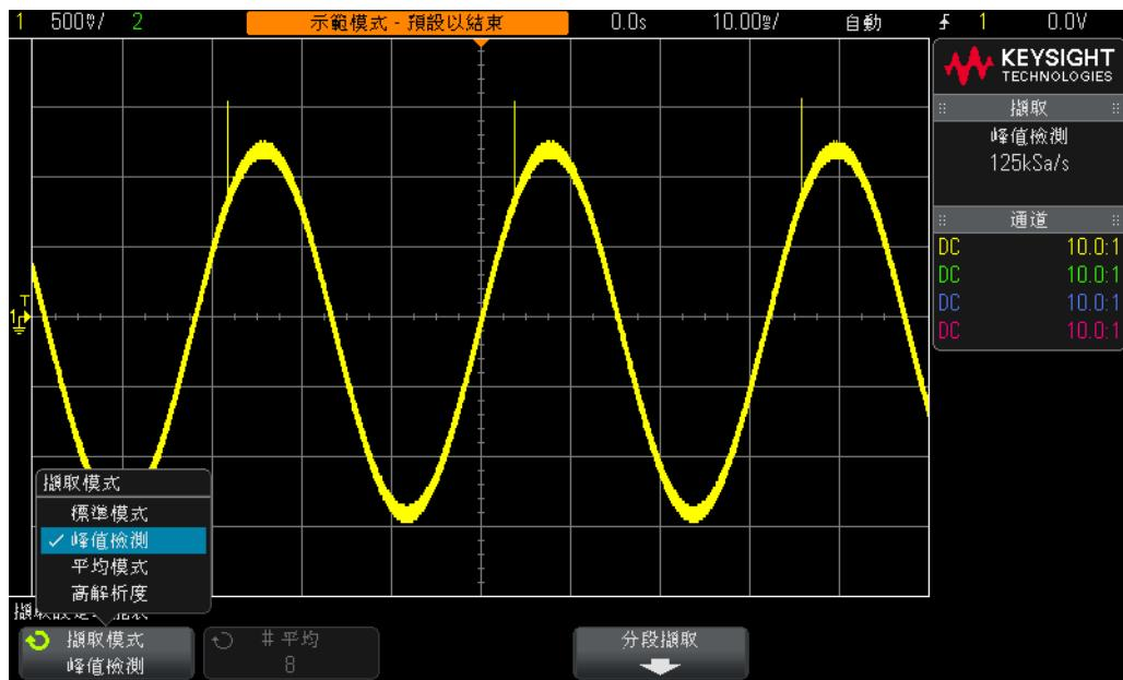
圖 45 「峰值檢測」擷取模式對帶有窄電磁波干擾的緩慢正弦波執行可靠擷取
