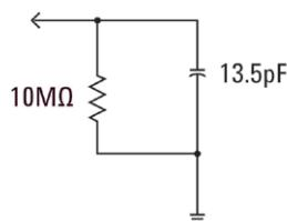
圖 23 10:1 被動測試棒和示波器負載模型
