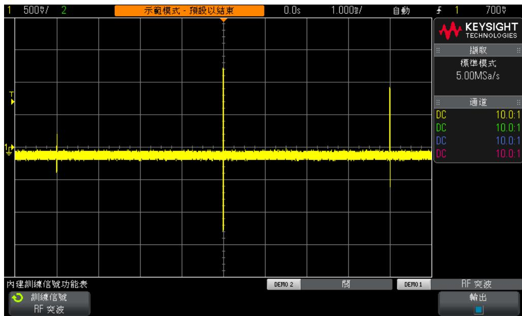
圖 47 使用較慢的時間基準設定擷取多個 RF 突波波形
