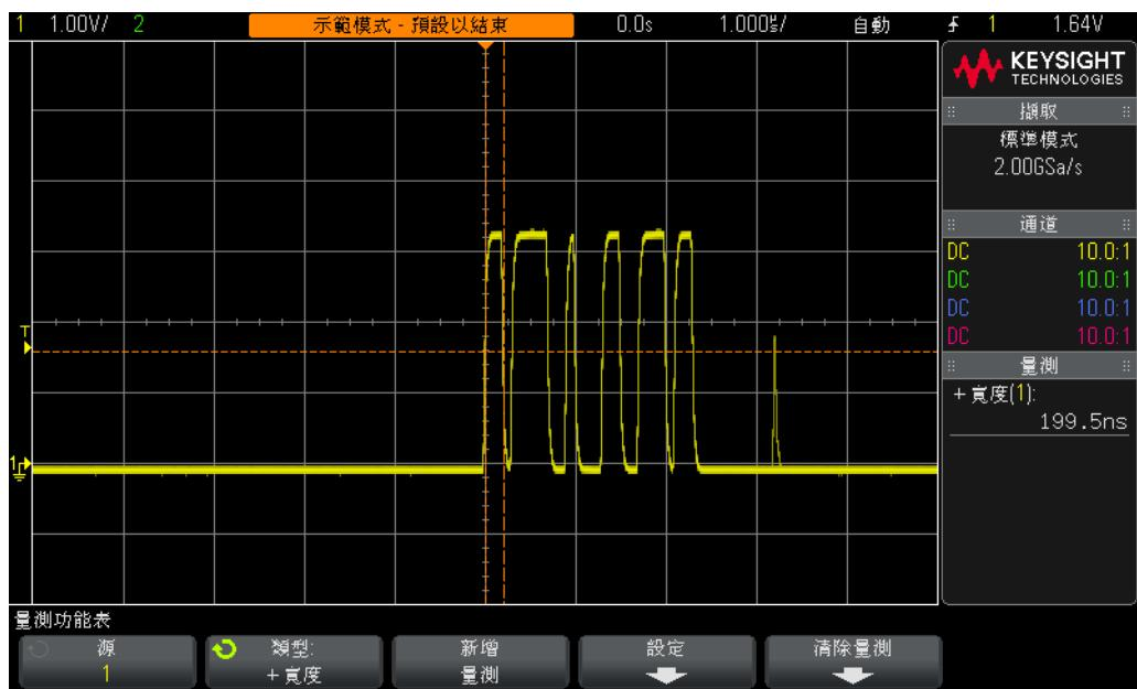
圖 37 量測突波中第 1 個脈波的正脈波寬度
