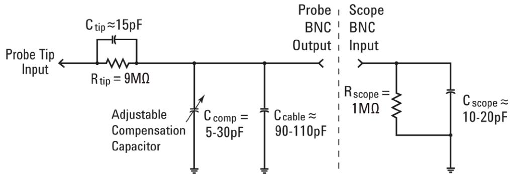
圖 3 連接至示波器  $1\text{ M}\Omega$  輸入阻抗之被動 10:1 測試棒的簡化電路圖
