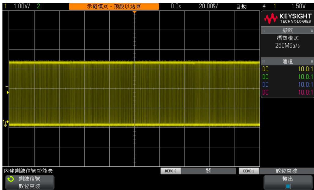
圖 25 試圖在使用示波器的預設觸發設定條件時檢視一組脈波
