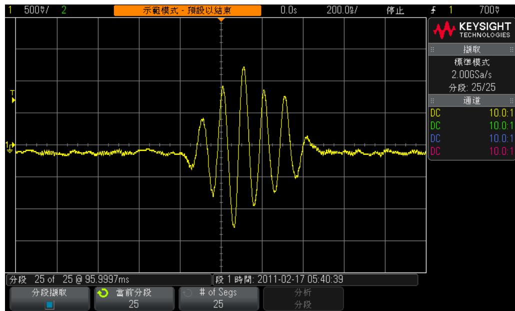
圖 49 使用分段記憶體擷取模式以高解析度擷取更多波形
