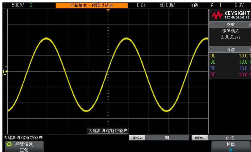
圖 9 用以檢視正弦波訓練信號的初始設定
