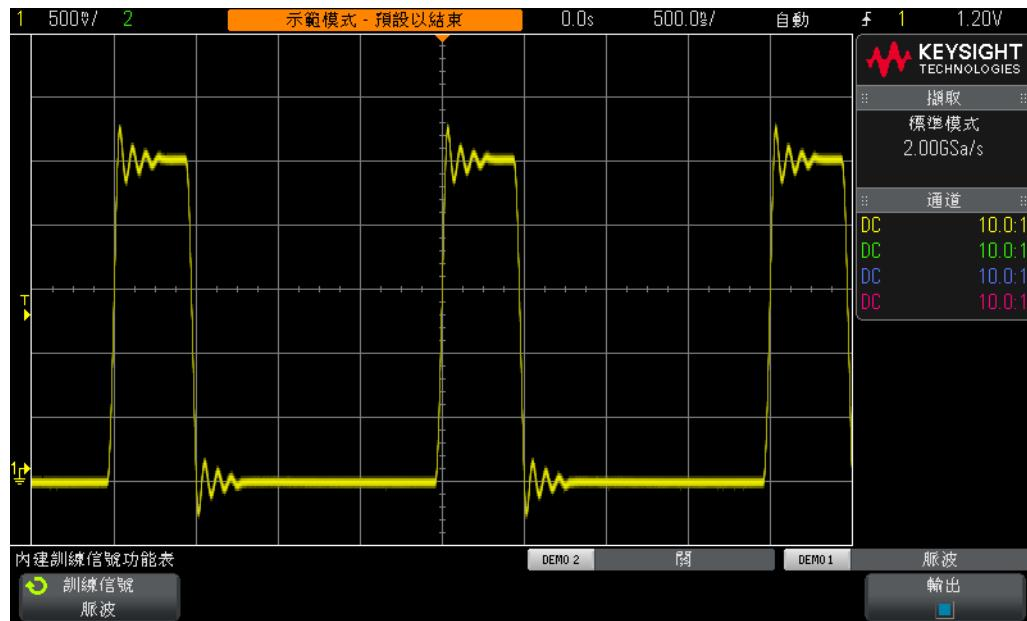
圖 31 示波器設定以擷取並顯示具有瞬變和過衝的重複數位脈波
