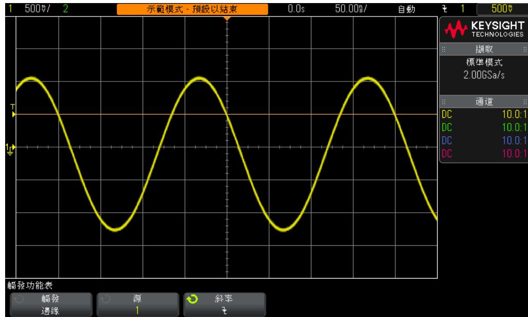
圖 13 針對正弦波的下降邊緣在 500 mV 處觸發
