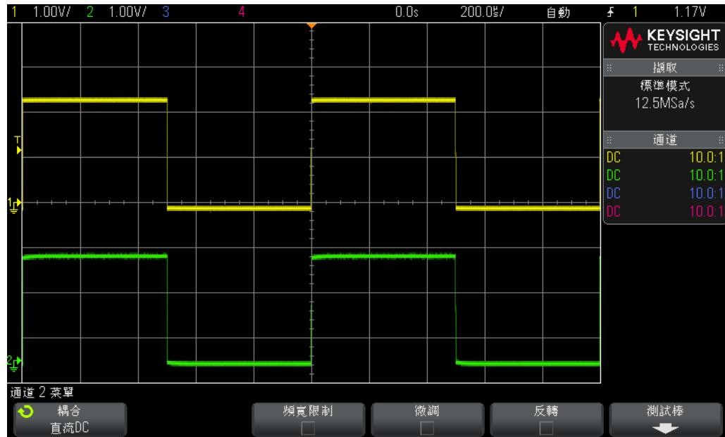
圖 21 使用示波器的 1 kHz 測試棒補償信號補償 10:1 被動測試棒
