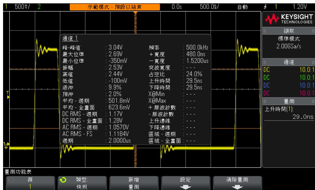
圖 35 使用「為所有項目製作快照」功能執行一組全面的自動參數量測
