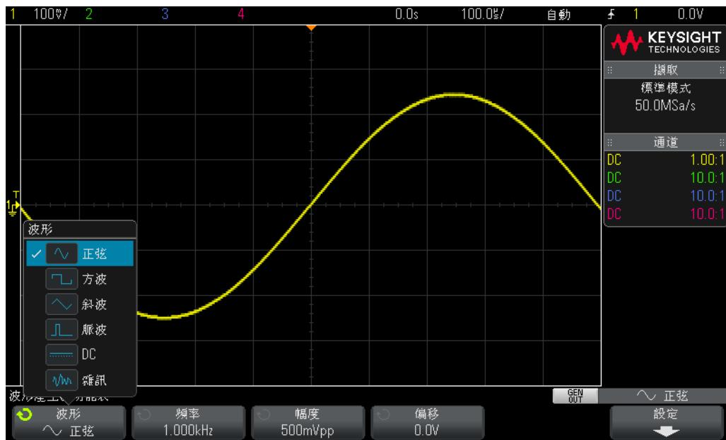
圖 24 使用示波器的內建 WaveGen 函數產生器
