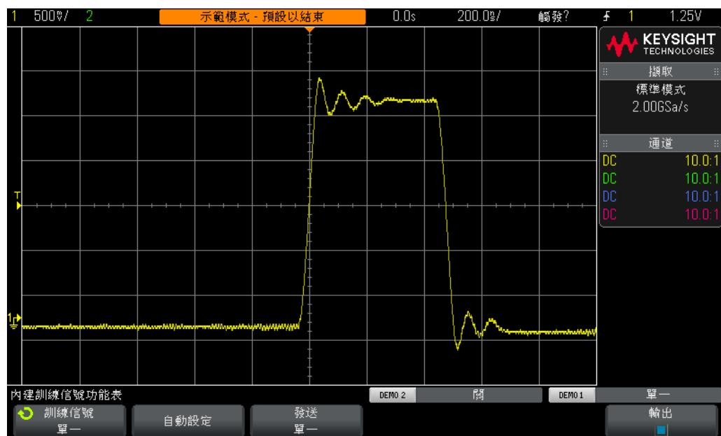
圖 30 設定示波器擷取單一事件
