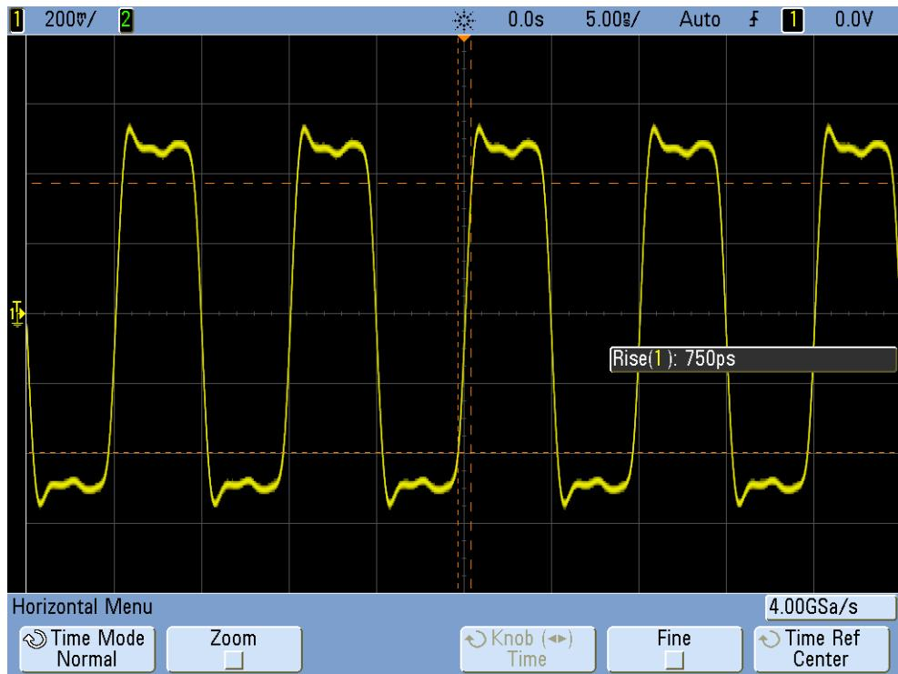
[圖 54](#) 在 500 MHz 頻寬示波器上擷取的 100 MHz 數位時鐘信號
