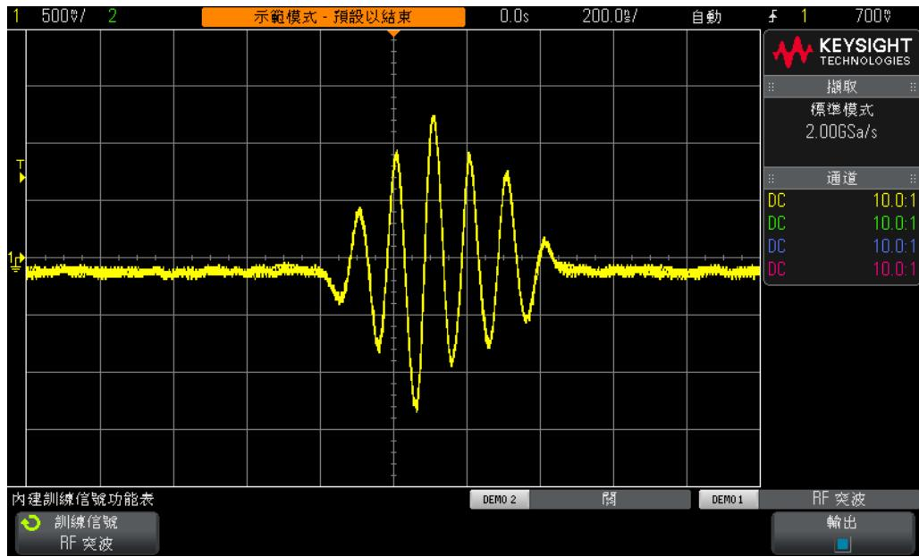
圖 46 摷取 RF 突波並以 200.0 ns/div 進行顯示
