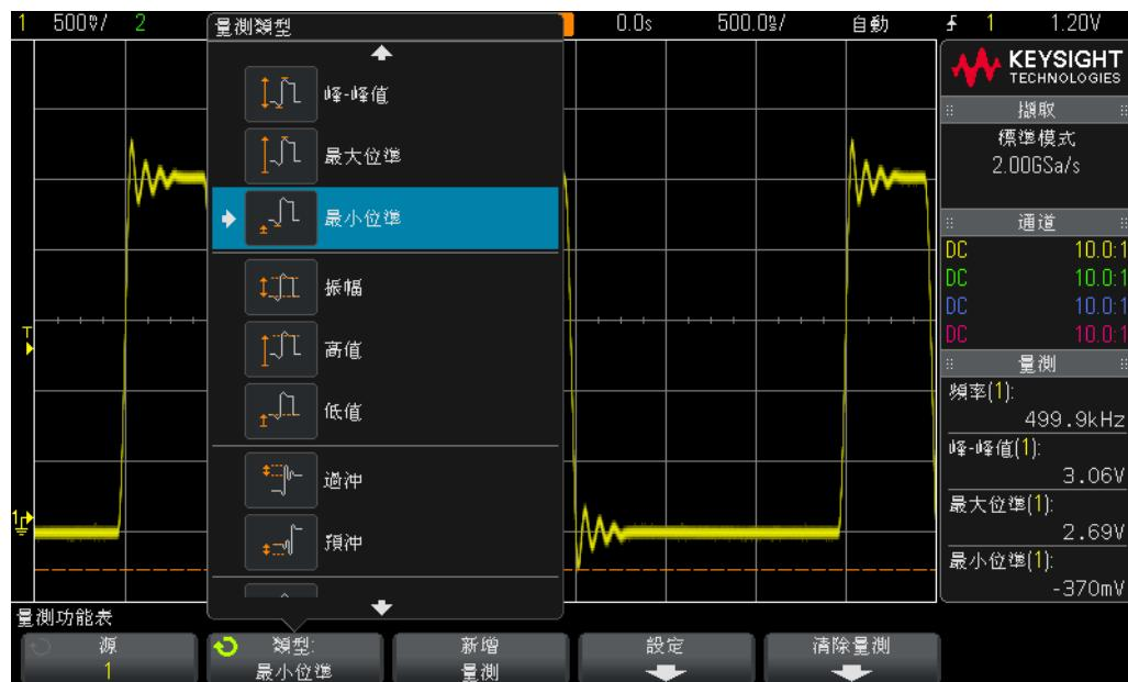
圖 32 示波器最多自動執行四個參數量測
