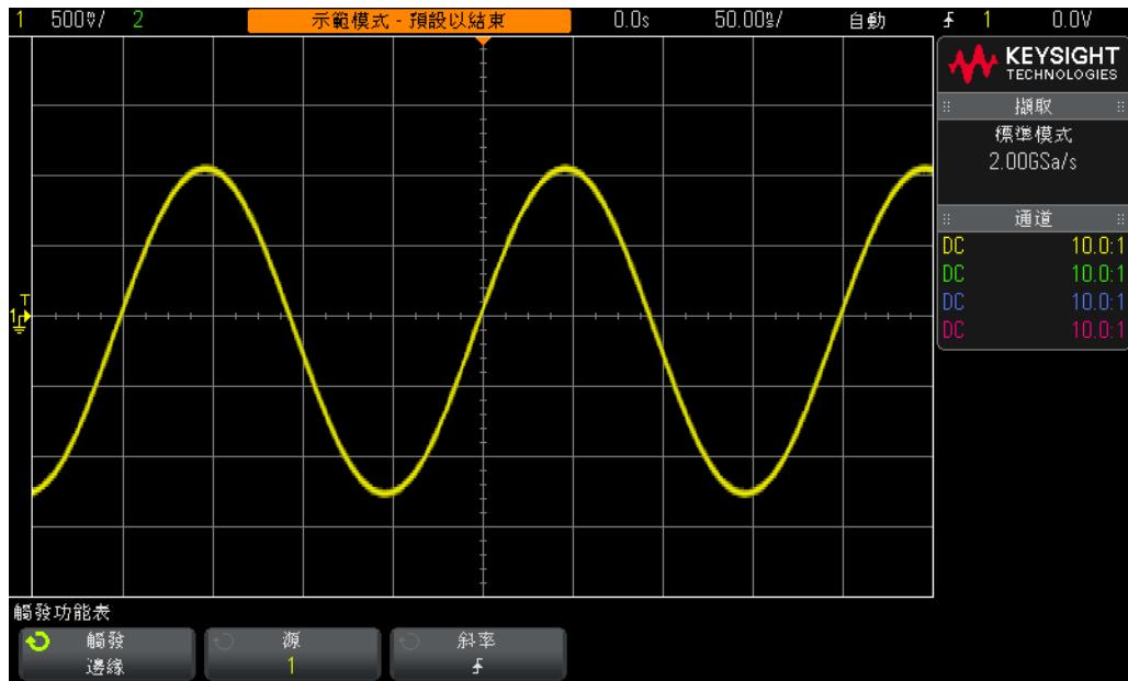
圖 12 針對通道 1 信號的上升邊緣在 0.0 伏處觸發示波器
