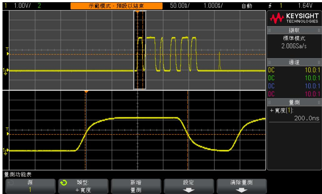
圖 38 使用示波器的「縮放」時間基準模式執行閘道量測
