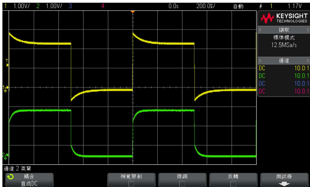
圖 22 不正確補償的測試棒
