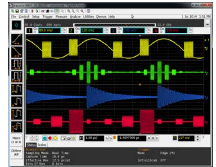
圖 7：高達 20 GHz 的 4 個不同脈衝信號
