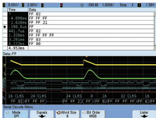
圖 2：螢幕上的 SPI 信號串列解碼，顯示出 MSO7104B 所擷取到的類比與數位波形產生時序連接。
