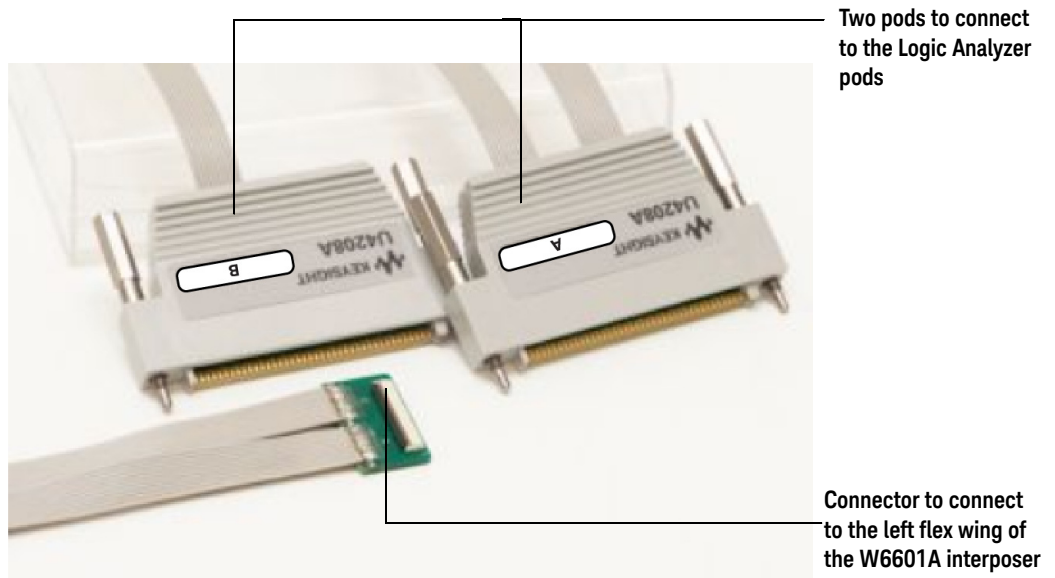
Figure 3 U4208A 61-pin ZIF probe cable
