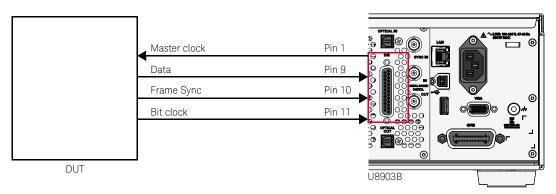
Figure A-7 DSI test configuration 4
