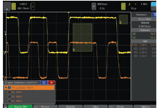
그림 33. 최대 4개까지 참조 파형 저장 및 호출
