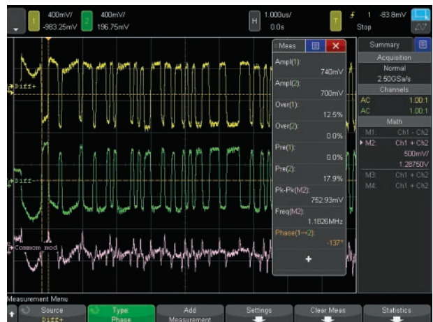
그림 23. 차동 임의 신호의 듀얼 채널 WaveGen 출력. 공통 모드는 연산 함수로 표시됩니다.
