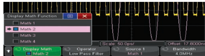
그림 31. 4개 연산 함수가 작성되고 중첩 사용되어 하나의 합성 연산 함수를 도출할 수 있습니다.
