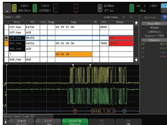
그림 20. USB 2.0 트리거, 디코딩 및 “리스트” 표시
