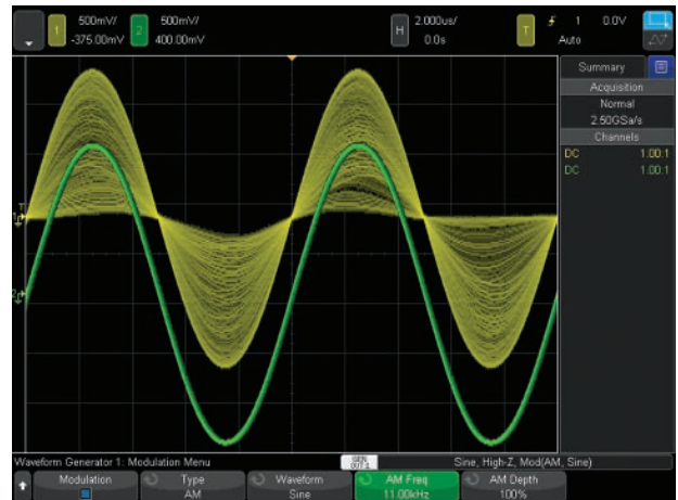
그림 21. AM 변조 추가된 그리고 추가되지 않은 WaveGen 사인파 출력
