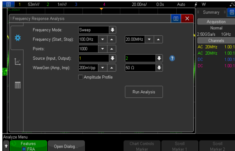
図3. InfiniiVisionの周波数応答解析アプリケーションの設定画面
