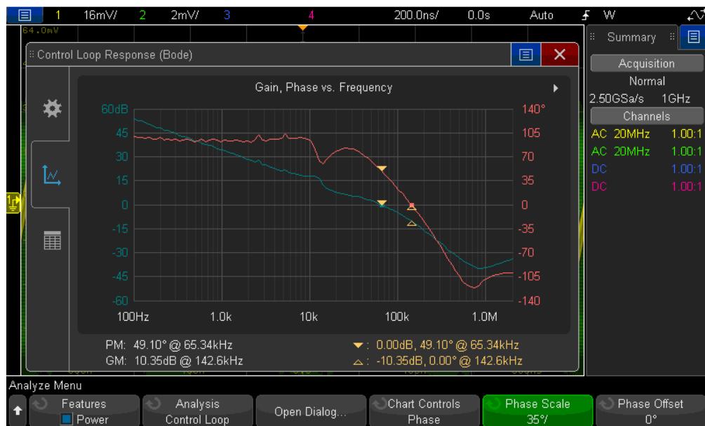
図9. スイッチング電源の負帰還回路の制御ループ応答テスト。
