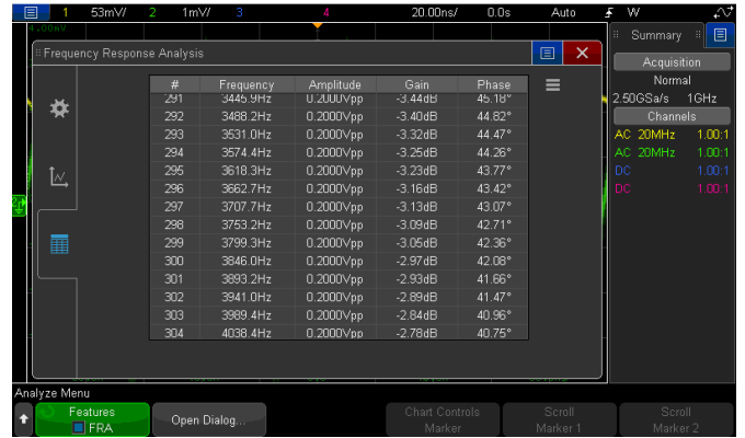
図5. 直列R-L-Cバンドパスフィルターの利得/位相のリスト (エクスポート可能な.csvフォーマット)
