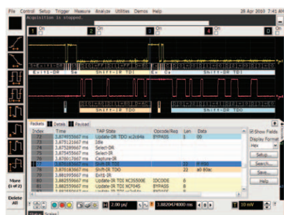
BSDLファイルのインポートとJTAGスキャン・チェーンのデコード。
