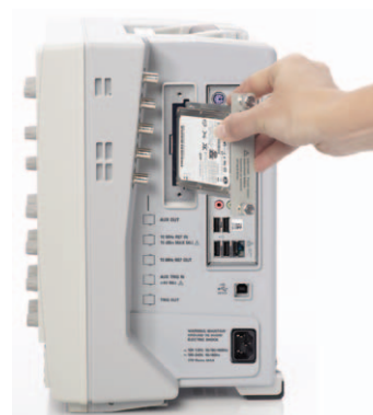
オプション801により、SSDを簡単に取り外して、セキュリティ保護できます。
