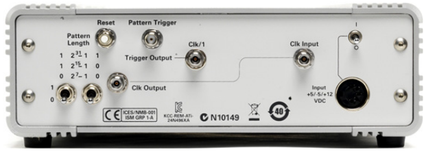
図2. N4974A PRBSジェネレーター 44 Gb/sの背面。 パターン制御スイッチ、クロック入出力、トリガ出力があります。
