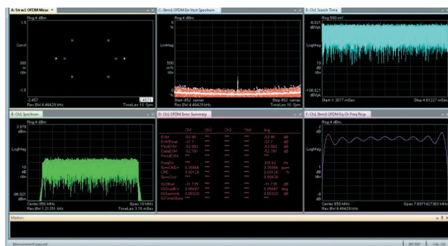
図8. M9703A広帯域デジタルレシーバーは、ダイナミックレンジに優れ、アナログミキサーがなくてもDVB-T信号を直接デジタイズでき、パッシブ・レーダー・アプリケーションに特に有効です。
