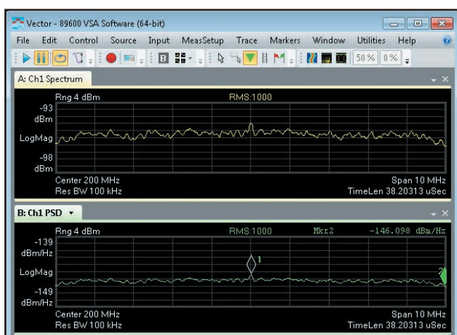
図4. M9703Aの1つのチャンネルで、89600 VSAを使用して測定されたノイズ・パワー・スペクトラム密度(NSD)。M9703Aは、 -145 dBm/Hzの非常に小さなNSDを実現し、一部の16ビットデジタイザと同等の性能を備えています。
