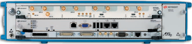
図21. Keysight M9703A AXIe 12ビットデジタイザとM9536A AXIeコントローラー1台をKeysight M9502A 2スロットAXIeシャーシにインストール。
