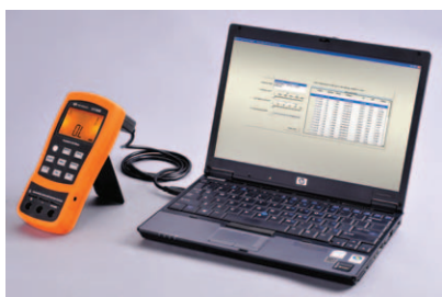
図1. U1701BをPCに接続すれば、連続した読み値を自動保存可能
