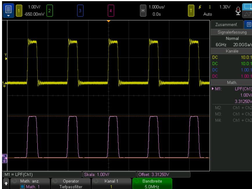
Abbildung 16 Beispiel für Tiefpassfilter
