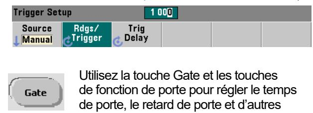
Utilisez la touche Gate et les touches de fonction de porte pour régler le temps de porte, le retard de porte et d'autres paramètres de porte.
