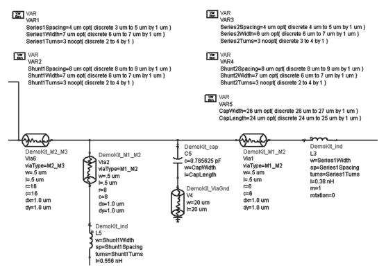
Figure 29. Optimized branch-line coupler parameter values
