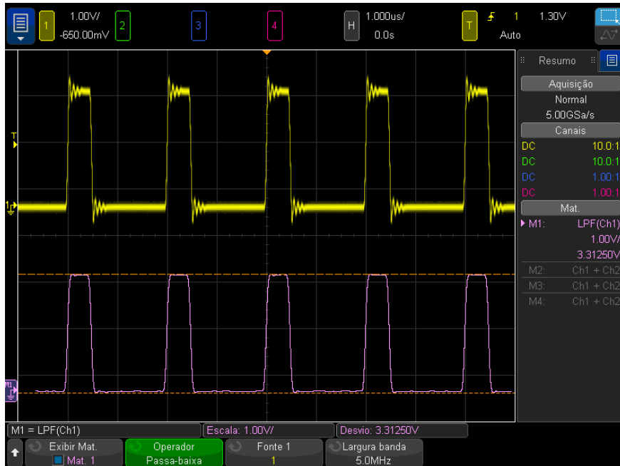
Figura 16 Exemplo de filtro passa baixo
