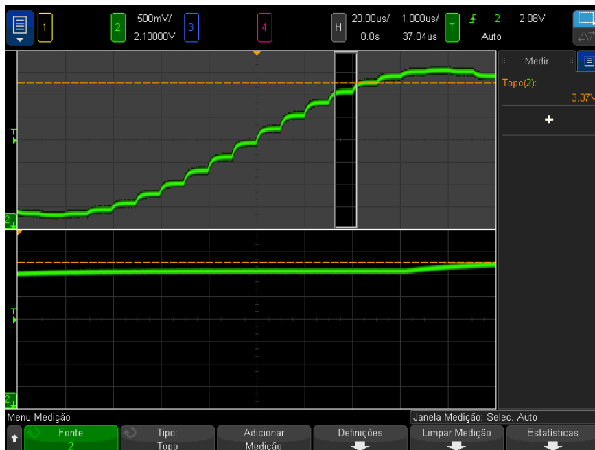
Figura 48 Isolar área para medição de topo
