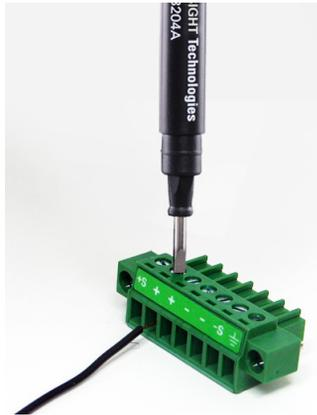
*Le blindage ne doit pas servir de conducteur pour la détection.* Le blindage doit être uniquement relié à la terre à l'extrémité de l'instrument U3606B. L'autre extrémité ne doit pas être raccordée. Respectez la polarité lorsque vous raccordez les cordons à la charge. Vous pouvez relier les cordons de sortie à l'une des deux bornes + ou -. Le court-circuit est interne.
