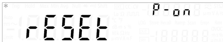
La procédure ci-après explique comment activer ou désactiver le rappel automatique du dernier état enregistré lorsque vous mettez l'appareil sous tension. Dans le cas d'une opération via l'interface distante, reportez-vous à la commande `MEMORY:STATE:RECALL:AUTO` dans le document *U3606B Programmer's Reference*.
