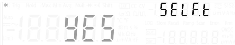
Appuyez sur [**Δ**] ou sur [**∇**] pour sélectionner « YES », puis sur [**Shift**] > [**Save**] pour enregistrer. L'instrument ferme automatiquement le menu Utility et exécute le test automatique.
