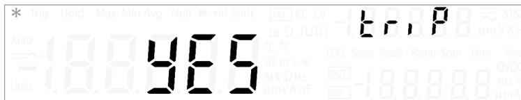
Les fonctionnalités OVP et OCP dépendent de la fonction d'état de protection de la sortie. L'état de protection de la sortie doit être activé pour les fonctionnalités OVP et OCP afin d'être actif dans le circuit. La désactivation de l'état de protection de la sortie désactivera les fonctionnalités OVP et OCP même si un seuil de déclenchement est défini pour OVP ou OCP.
