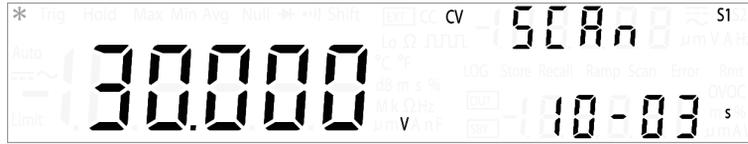
Appuyez sur **[Voltage]** ou sur **[Current]** si vous souhaitez configurer les paramètres du balayage pour la sortie CV ou CC.
