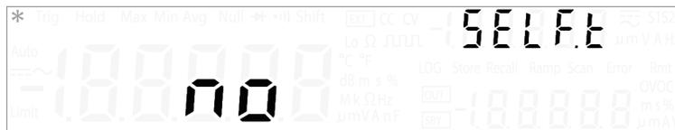
L'instrument effectue automatiquement un test lorsque vous le mettez sous tension. Ce test succinct vous permet de savoir si l'instrument U3606B est opérationnel.
