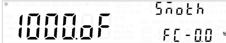
La fonction non paramétrique est une moyenne spéciale à court terme qui diffère de la fonction moyenne de fonctionnement MinMax. La fonction non paramétrique filtre le bruit et stabilise les résultats. La fonction moyenne de fonctionnement MinMax est considérée comme une moyenne à long terme parce qu'elle utilise tous les résultats pour faire la moyenne.
