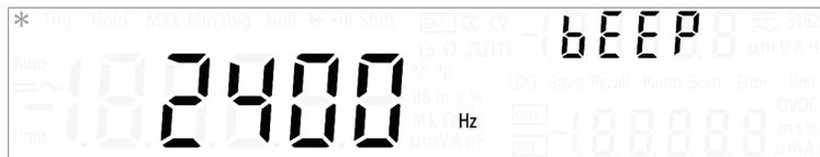
En principe, l'instrument U3606B émet un signal sonore lorsque certaines conditions sont réunies (par exemple, l'instrument U3606B sonne lorsqu'une valeur est stable en mode gel de données). Par défaut, la fréquence du signal sonore est « 3 840 Hz ». Vous pouvez toutefois la désactiver via le panneau avant.
