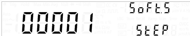
L'instrument U3606B vous offre l'option du démarrage progressif de la sortie d'alimentation en courant continu. Vous pouvez sélectionner une valeur de 1 à 10 000 étapes pour la sortie de démarrage progressif. Cette fonctionnalité est utile pour faire démarrer un moteur CC. La valeur de l'étape de démarrage progressif par défaut est 1.
