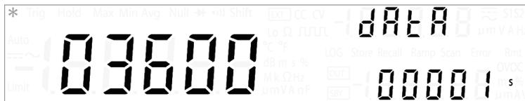
La fonction d'enregistrement des données vous offre la possibilité d'enregistrer des données de test pour révision ou analyse ultérieure. Les données étant stockées dans la mémoire non volatile, elles sont sauvegardées même si l'instrument U3606B est hors tension (OFF).
