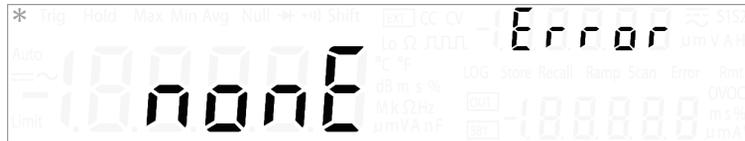
Lorsqu'aucune erreur n'est enregistrée dans la file d'attente, le message “nonE” apparaît dans la zone d'affichage principale.
