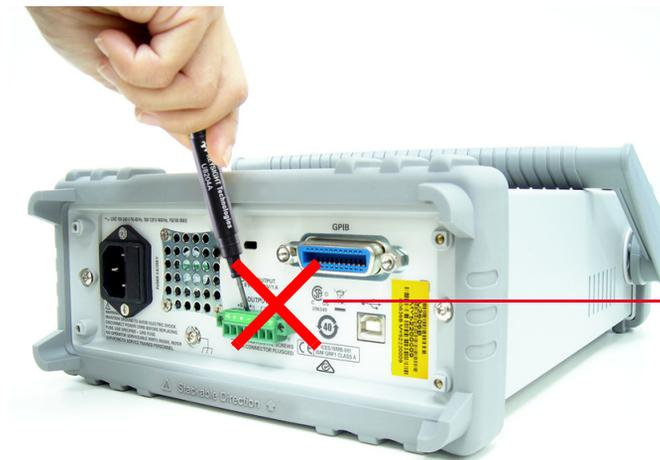
N'inclinez pas le tournevis lorsque vous dévissez les vis supérieures sur le bornier en face arrière.
