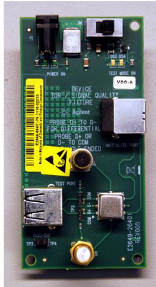
このフィクスチャはモデル番号 E2666B で注文できます。これには、2 個の RF SMA (m) 垂直 50Ω 終端コネクタと 2 個の 4 インチ USB A-B 間ケーブル (E2646-61601)、USB 2.0 プラグ、USB 2.0 Micro プラグ、標準 USB ホストからフィクスチャに電源供給するケーブルが含まれています。
