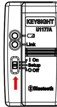
Coloque el interruptor deslizante en la posición de **Configuración**.
