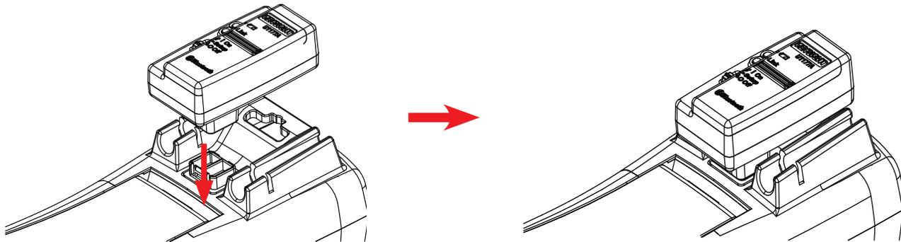
Ajuste la parte óptica del U1177A en el puerto de comunicación IR del multímetro.
