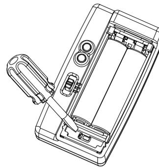
2. Utilisez un tourne-vis à lame plate pour pousser le bouton situé dans le trou pendant approximativement trois secondes.
