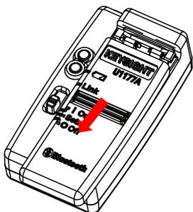
1. Rimuovere il coperchio del vano batterie e allontanarlo dall'adattatore.
