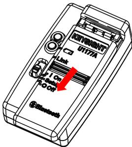
1. Deslice la tapa de la batería fuera del cuerpo del adaptador.
