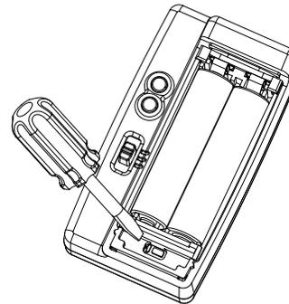
1. Aprire il coperchio del vano batterie. Impostare il selettore a scorrimento su **Setup**.
