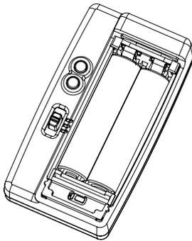
1. Abra la tapa de la batería. Luego, coloque el interruptor deslizante en la posición de **Configuración**.
