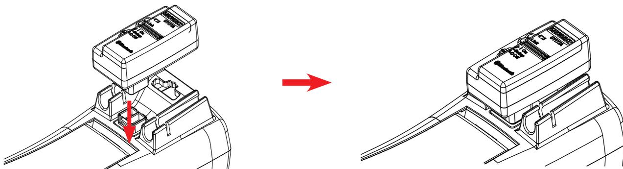
Inserire il lato ottico dell'U1177A nella porta di comunicazione IR del multimetro.
