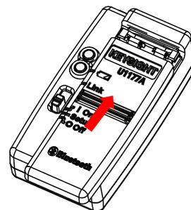
3. Per richiudere il coperchio del vano batterie, inserire in senso opposto.
