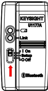
Coloque el interruptor deslizante en la posición de **Encendido**.
