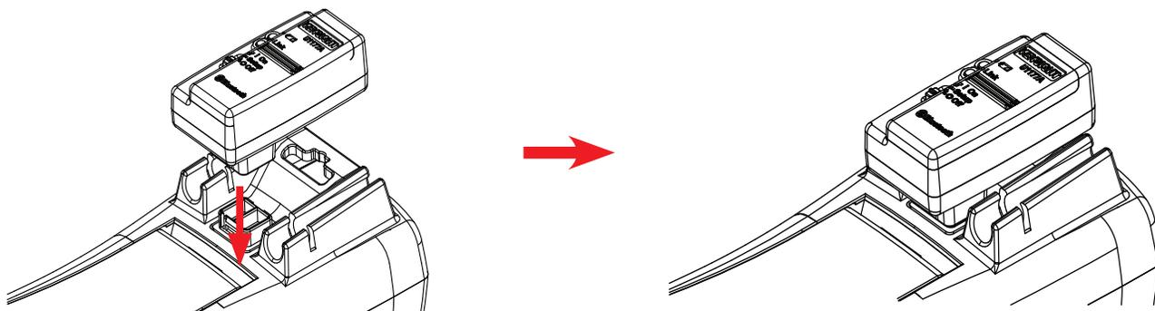
Connectez la partie optique de l'U1177A au port de communication IR du multimètre.
